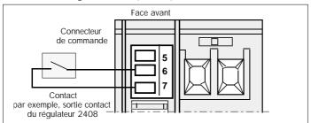
Exemple de branchement de contact de contrôle (vue de dessous)
