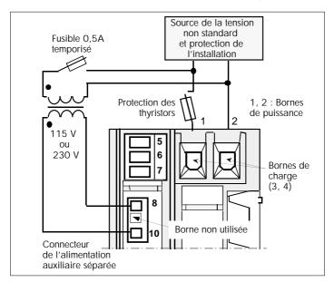
Exemple de branchement de l'alimentation auxiliaire en cas du réseau non standard
