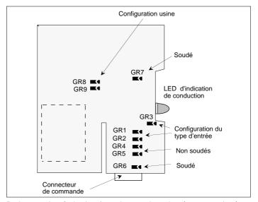
Emplacement des «Grains de café» sur la carte électronique (vue côté soudures)
