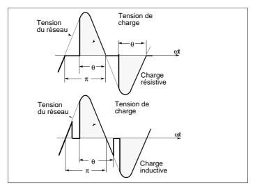
Tension de charge en mode de conduction «Angle de phase»  $(\Theta: \text{ angle de conduction d'un thyristor})$
