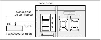
Exemple de branchement d'un potentiomètre externe (vue de dessous)
