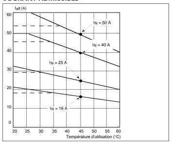
Courbes de courant admissible en fonction de la température ambiante ( $I_N$  = courant nominal à 45°C)
