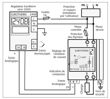
Exemple de branchement du TE10A (réseau 230 V, entrée 0 -10 V)
